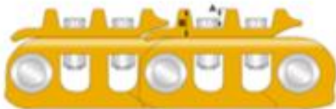
Altura de zapata
